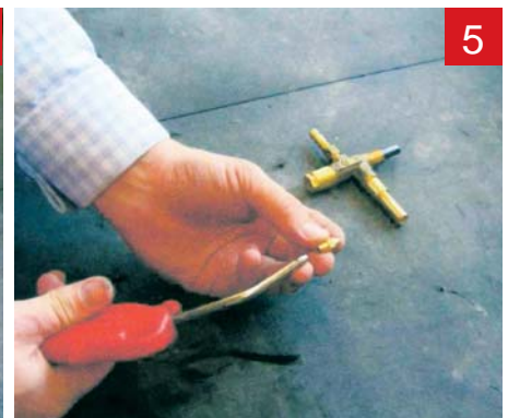
Clean injector coupling with air pressure 使用气压清洗喷射器的接口
