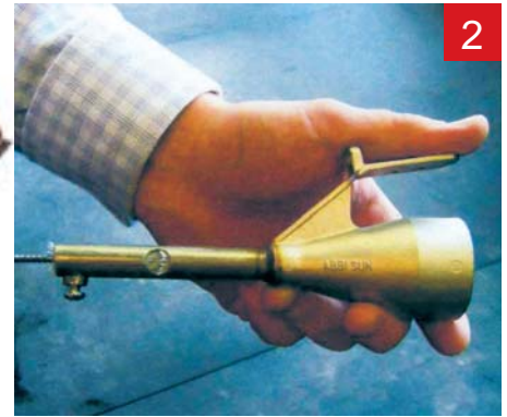
Using a brush to clean the Venturi 使用刷子清洗通气管
