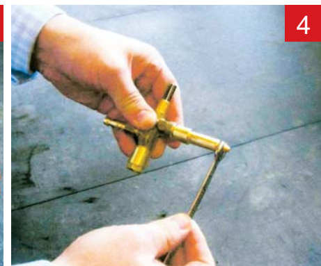
Loosen the injector coupling 松开喷射器的接口
