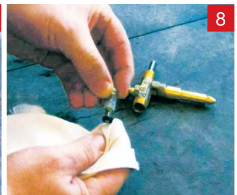
Clean magnet unit with soft towel 使用柔软的毛巾干净磁铁单元
