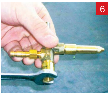
Open the injector 打开喷射器
